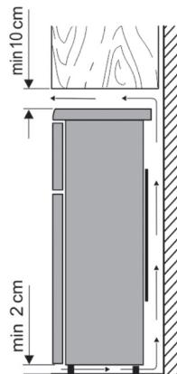
Die hinter dem Gerät aufgewärme Luft muss frei zirkulieren können. Aus diesem Grund dürfen Sie die Luftzirkulation nicht beeinträchtigen.
