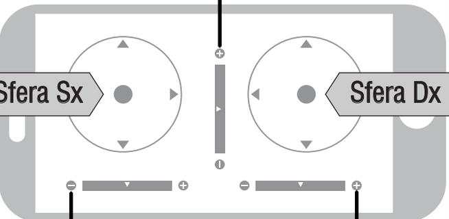
Se il drone ruota in senso orario, spostare l'interruttore del TRIM rotazione verso sinistra fino a quando il drone non mantiene una posizione corretta.
