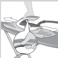
Den intelligente sensor **DynamIQ** inde i dit strygejern ved præcis, hvornår og hvordan dit strygejern er i bevægelse. Når du aktiverer intelligent automatisk damp tilstand, vil sensoren **DynamIQ** begynde at genkende dit strygejerns bevægelser og gøre dit strygejern i stand til at frigøre den rette mængde damp automatisk, uden at du skal trykke på dampudløseren. Dette vil hjælpe dig med at opnå fantastiske strygeresultater hurtigere og nemmere.
