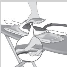
*Remarque : en mode Vapeur automatique intelligente, la vapeur sort automatiquement de l'appareil lorsque vous déplacez le fer et s'arrête lorsque vous ne déplacez pas le fer. Vous pouvez toujours appuyer sur la gâchette vapeur dans ce mode pour activer la vapeur lorsque le fer n'est pas en mouvement.*
