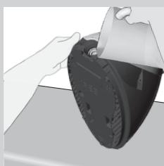
**6** Houd het apparaat zodanig vast dat de EASY DE-CALC-opening naar boven is gericht en giet 900 ml gedistilleerd water in de opening.
