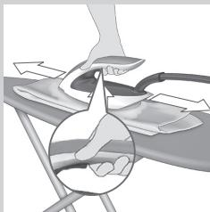
*Nota: in modalità vapore automatico intelligente, il vapore esce automaticamente quando si sposta il ferro e si interrompe quando lo si tiene fermo. È possibile premere il pulsante del vapore in questa modalità per attivare il vapore quando il ferro non è in movimento.*
