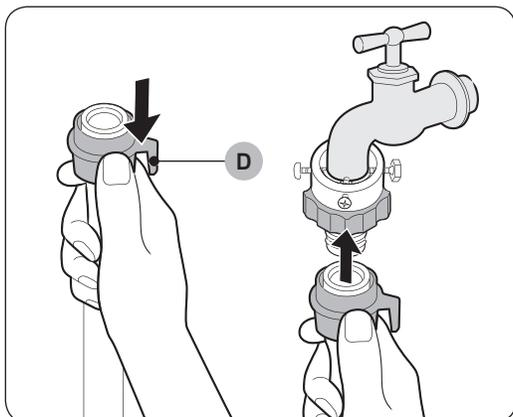
6. Tenendo abbassata la **parte (D)**, collegare il tubo di carico dell'acqua all'adattatore. Quindi rilasciare la **parte (D)**. Il tubo si inserisce nell'adattatore con uno scatto.
