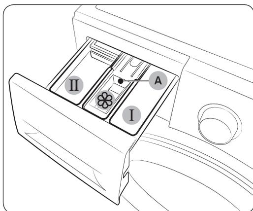
1. **I** Comparto prelavaggio: Inserire detersivo per il prelavaggio.
