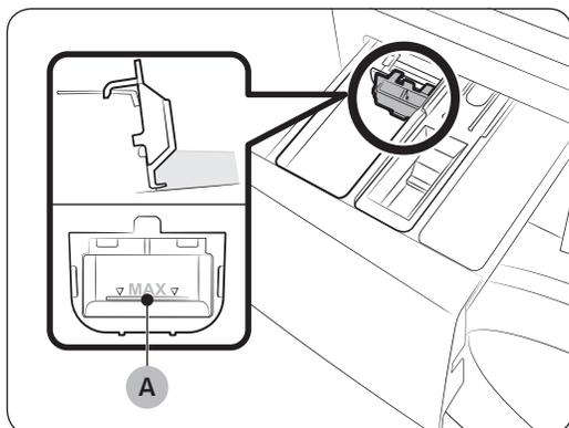
Inserire per primo la guida per detersivi liquidi in dotazione nel **II** comparto lavaggio principale. Quindi, versare il detersivo liquido nella guida al di sotto della linea max (A).
