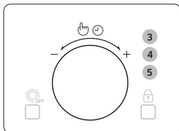
3. Selezionare il livello di potenza appropriato ruotando il **Selettore multifunzione** fino a quando viene visualizzata la potenza corrispondente (600, 450, 300, 180, 100 W). Quindi premere il **Selettore multifunzione** per impostare il livello di potenza.
