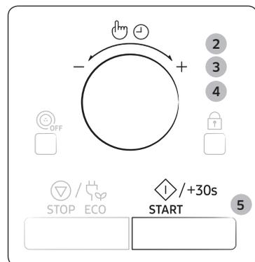
2. Impostare la temperatura ruotando il **Selettore multifunzione**. (Temperatura: 40-200 °C, con intervalli di 10 °C)
