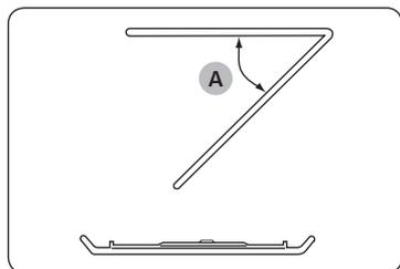
Per pulire l'area superiore del vano di cottura, abbassare l'elemento riscaldante superiore di 45° (A) come mostrato. Ciò consentirà di pulire l'area superiore in modo più agevole. Al termine, riposizionare l'elemento riscaldante superiore.
