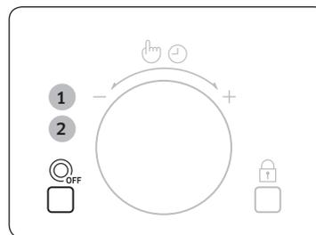
1. Premere il tasto **Piatto girevole On/Off** durante l'impostazione della funzione Microwave (Microonde), Grill, Hot Blast (Cottura Ventilata), Preheat (Preriscaldamento) e Combi (Combinata).
