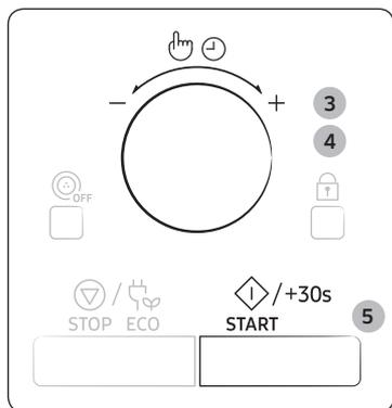
3. Selezionare il livello di potenza appropriato ruotando il **Selettore multifunzione** fino a quando viene visualizzata la potenza desiderata (600, 450, 300 W). Quindi premere il **Selettore multifunzione** per impostare il livello di potenza.
