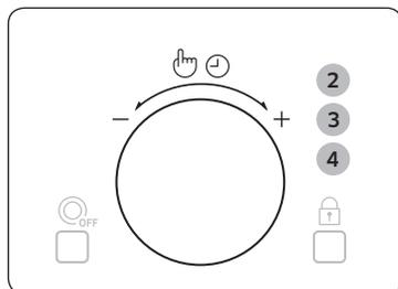
2. Ruotare il **Selettore multifunzione** per selezionare la tipologia di cottura desiderata. Quindi premere il **Selettore multifunzione** per selezionare la tipologia di alimento.
