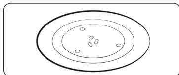
**02 Piatto girevole**, da collocare sull'anello girevole con l'elemento di montaggio centrale posto sull'accoppiatore. Il piatto girevole è la superficie di cottura principale; può essere facilmente smontata per la pulizia.
