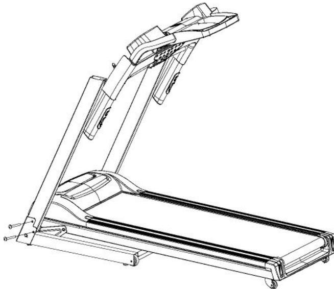
**Passo 3:** girare la console del computer e portarla in posizione orizzontale; fissare la console ai montanti usando 2 viti M8\*15.
