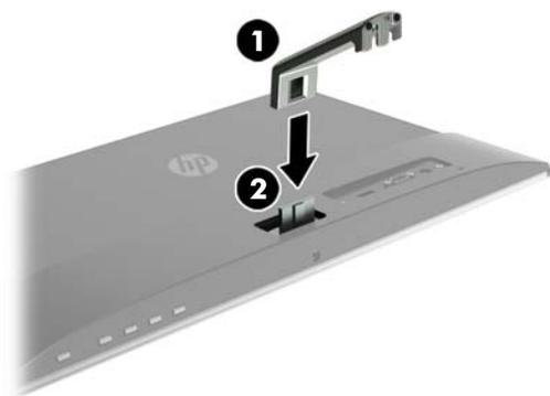
3. Far scorrere la base (1) nella parte inferiore del braccio di supporto fino a quando i fori centrali siano allineati. Quindi stringere la vite (2) sul lato inferiore della base.
