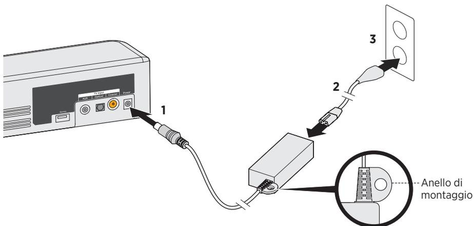
2. Inserire un'estremità del cavo di alimentazione nell'alimentatore.
