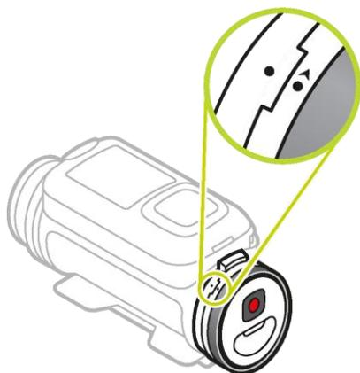
6. Ruota il cappuccio in senso orario per bloccare la Batt-Stick all'interno della videocamera.
