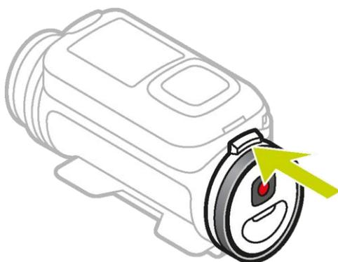
2. Tenendo la leva ruota il cappuccio in senso antiorario finché non vedi due punti allineati.
