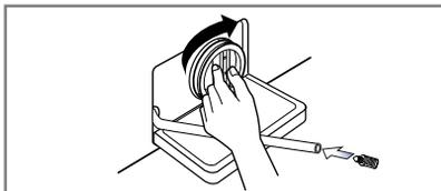
4. Dopo la pulitura, ruotare il filtro della pompa e inserire il tappo di scarico.
