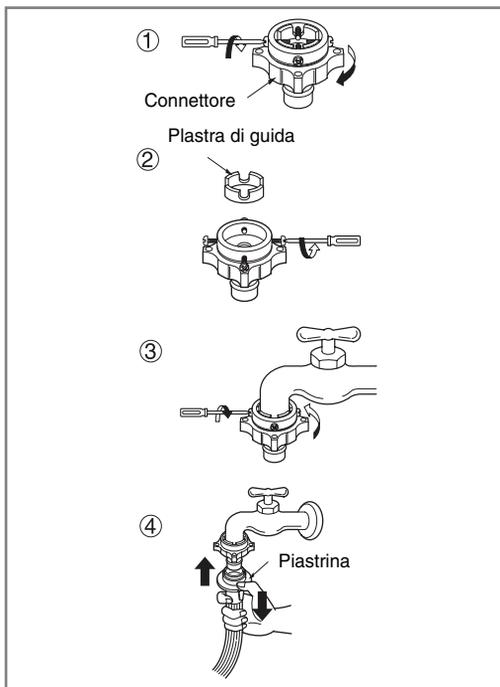
1. Svitare la piastra dell'anello adattatore e le 4 viti di fissaggio dell'adattatore.
