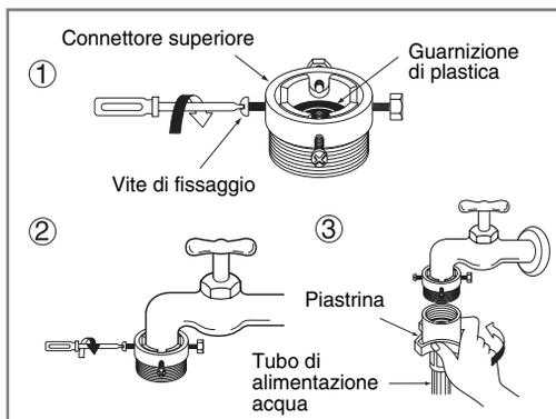
1. Svitare la piastra dell'anello adattatore e le 4 viti di fissaggio dell'adattatore.
