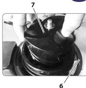
7. Posizionare il coperchio (8) sul separatore (4). Allineare il simbolo ▼ presente sul coperchio (8) con quello presente sul separatore (4). Ruotare il coperchio in senso orario nella posizione di blocco; il coperchio scatta in posizione.
