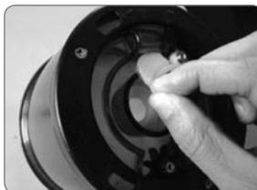
3. Posizionare il separatore (4) sulla base motore (1) assicurandosi che i 3 fori (x) presenti sul separatore siano allineati con i tre riscontri presenti sulla base motore. Premere verso il basso il separatore (4) e ruotarlo in senso orario per bloccarlo in posizione.
