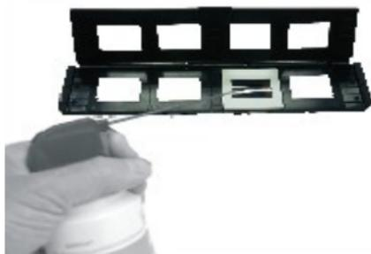
**Attenzione:** Maneggiate le diapositive con cura. Polvere, graffi e impronte possono danneggiare la diapositiva e rovinare l'immagine. Per preservare l'integrità delle vostre diapositive è consigliato l'uso di guanti in cotone. Per rimuovere la polvere è possibile utilizzare appositi dispositivi ad aria compressa.
