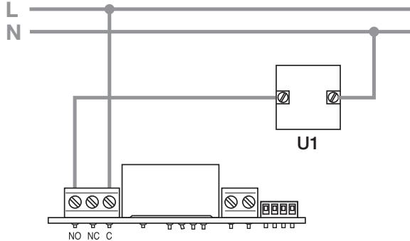
Valvole motorizzate • Motor-operated valves • Vannes motorisées
