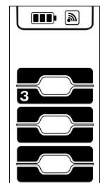
Bei erfolgreicher Kopplung werden nun alle 6 Druckstufen im Display angezeigt.
