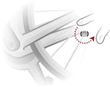
3. Regola la posizione del magnete per raggio e del sensore per foderi orizzontali in modo tale che quando la ruota gira, il magnete per raggio superi la parte superiore del corpo principale del sensore per foderi orizzontali.
