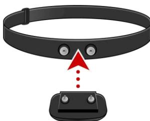
2. Lega il cinturino attorno al torace, in modo che il dispositivo di monitoraggio sia situato sopra la base dello sterno.
