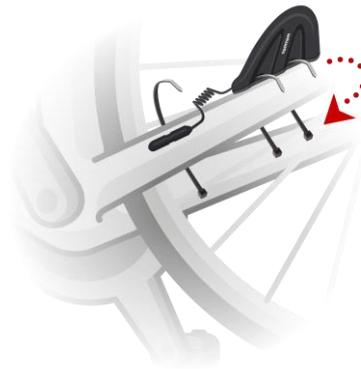
2. Fissa il magnete per raggio a uno dei raggi della bici. Il magnete deve essere rivolto verso i foderi orizzontali in cui è stato fissato il sensore per foderi orizzontali.
