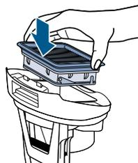
Rimetti il filtro di aspirazione nella parte superiore del serbatoio dell'acqua sporca.
