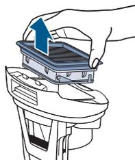
Rimuovi il filtro dalla parte superiore del serbatoio dell'acqua sporca tirandolo verso l'alto.
