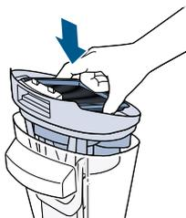
Una volta che le parti sono asciutte, riassume e riposiziona la parte superiore del serbatoio dell'acqua sporca.
