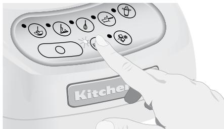
4. Selezionare un pulsante per la velocità e tenerlo premuto per il tempo desiderato. Quando è attiva la funzione a PULSE (Pulse) a una determinata velocità, rimangono illuminate entrambe le spie delle modalità corrispondenti. Quando si rilascia il pulsante, la miscelazione si arresta, ma la modalità PULSE (Pulse) resta attiva e la spia correlata
