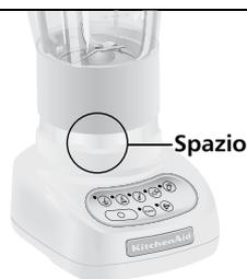
La caraffa non è fissata correttamente al collare di blocco, impedendo ai denti di ingranare. Rimuovere la caraffa dalla base e inserirla a fondo nel collare. Premere e ruotare la caraffa in senso orario nel collare di blocco fino a sentire due clic. In questo modo il gruppo della caraffa sarà in grado di attivare gli ingranaggi. Vedere la sezione Frullatore a pagina 5.
