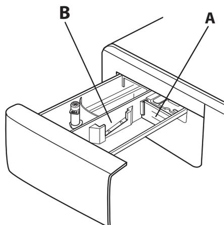
Nel caso di utilizzo di detersivo liquido per il lavaggio, si consiglia di utilizzare la paretina **A** per un corretto dosaggio (la paretina è in dotazione e si trova all'interno del sacchetto con le Istruzioni).
